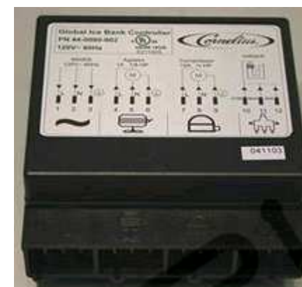
Controle de banco de gelo 110V
